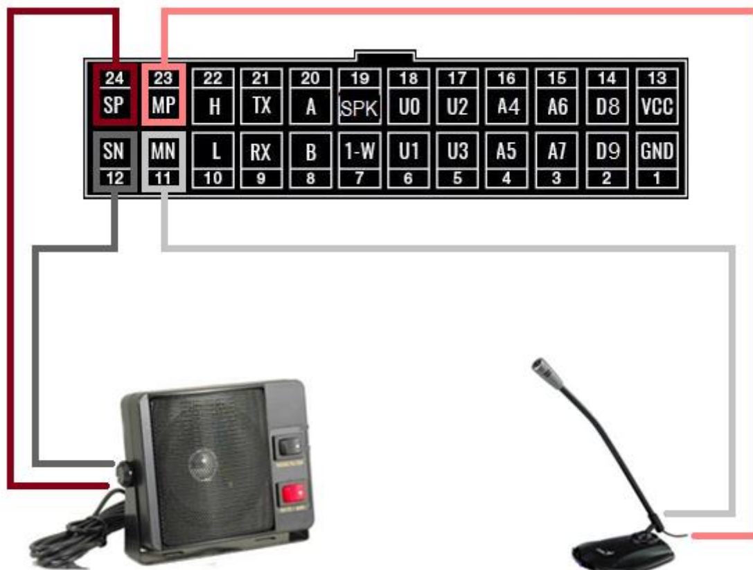
Рисунок 9 – Схема подключения микрофона и динамика
